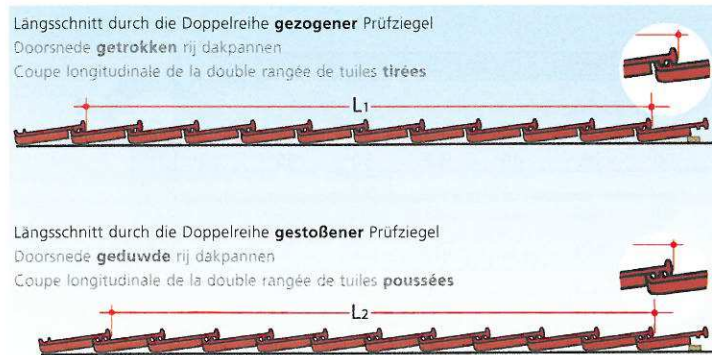
Orientierungs-Decklängen (cm) nach Anzahl der Flächenziegelreihen Latafstand (cm) met het aantal rijen pannen (ter orientatie) Longueurs de couverture d'orientation (cm) en fonction du nombre de rangées de tuiles
